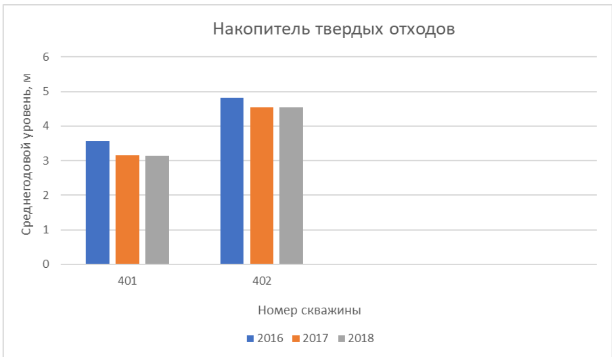
Рисунок 4 - Среднегодовой уровень воды в накопителе твердых отходов
